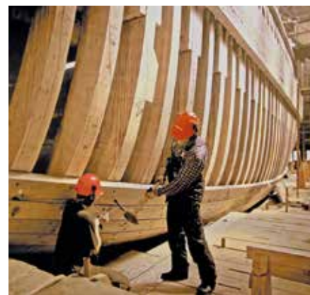
Bordläggning. Allt arbete utförs med verktyg, byggmetoder och material från 1700-talet.
