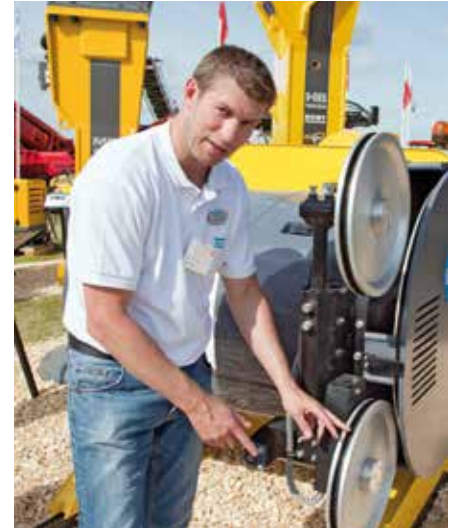
Stefan Svensson vid Atlas nya Stonetech diamanthuggare, 100 hkr och automatisk kontroll av vajerns spänning.
