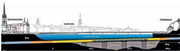
Mellan Riddarholmen och Söder Mälmarstrand ligger berget för djupt för att Citybanan ska kunna fortsätta att gå i en bergtunnel.
