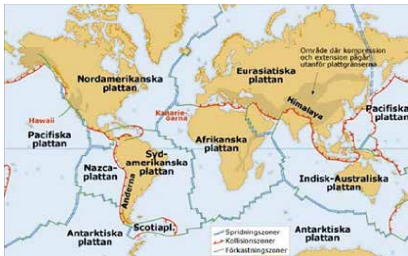
Karta över de 15 litosfärplattorna. Gränserna utgörs av spridnings-, kollisions- och förkastningszoner. Genom Island går en spridningszon. Plattorna går ned till ett djup på 10-15 mil.
