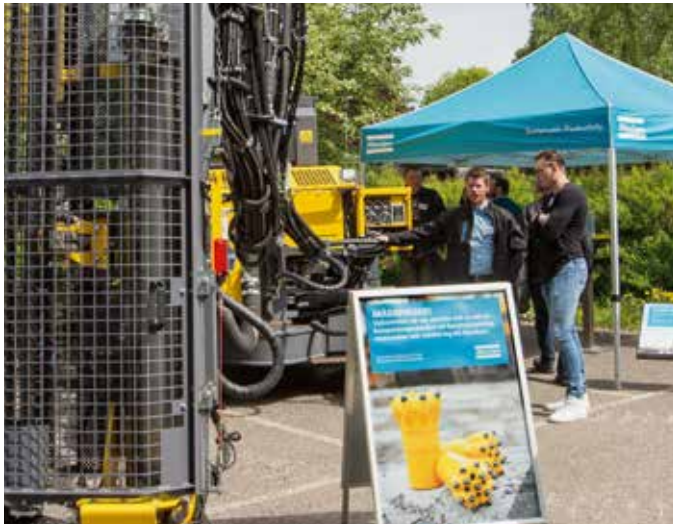
Stefan Norberg presenterar Atlas Copcos T 30 som försetts med bland annat nytt stånghammarsystem, smidig gallerbur och ny borr.
