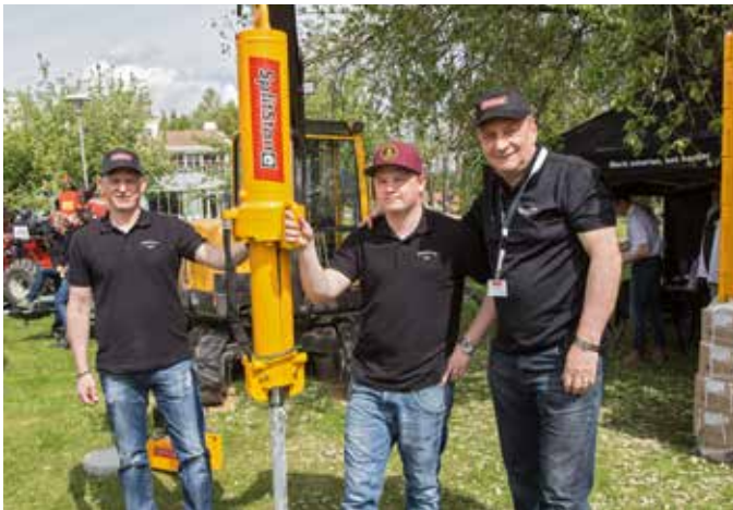
Pierre och Max Franzell, Swedeq, Åkersberga, och Seppo Leppälä, SplitStone, vid spräckcylindern S150. Vikt 170 kg och borrdiameter 51 mm. Den kan bäras av en minigrävare men klarar stora jobb.
