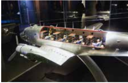
DC3:an var utrustad för signalspaning av ryska luftförsvarets radiokommunikation och deras radarstationer.
