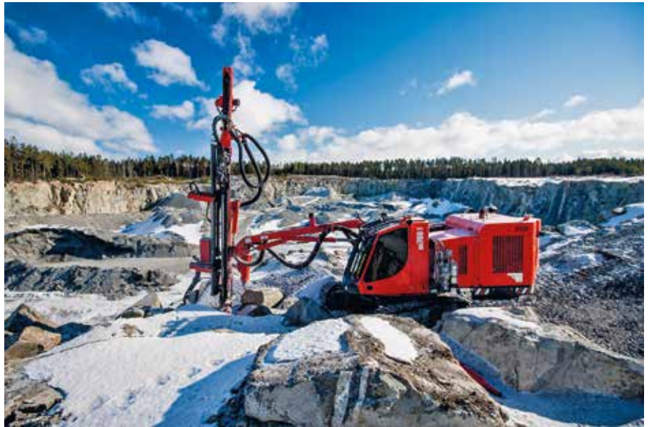
Sandvik DX780 för ovanjordsborrning. Det nya navigeringssystemet TIM3D V2 finns för topphammarriggar i Sandviks DX-serie.
