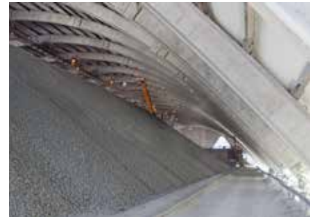
Lager av mägersten (karbonat och silikatbergarter) som ska blandas med kalksten i rätt proportion vid cementtillverkningen.
