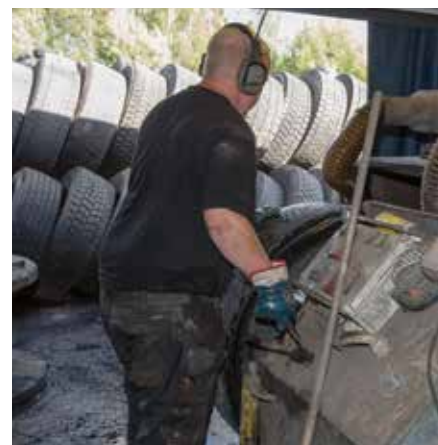
Kenny vid maskinen som skär bort lastbilsdäckens sidor. Endast slitbanorna används i sprängmattorna.
