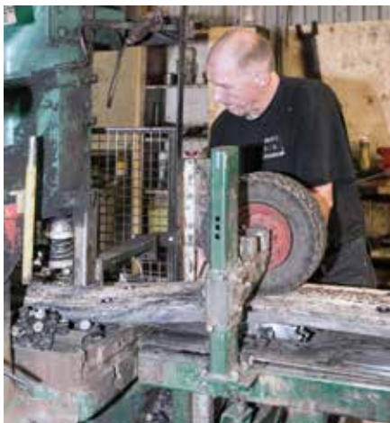
Tage stansar hål för vajrarna med en 60 tons stans.
