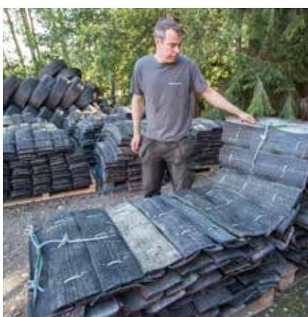
Efterfrågan på handmattor till stenspräckning har ökat starkt senaste åren. De tillverkas av personbilsdäck.
