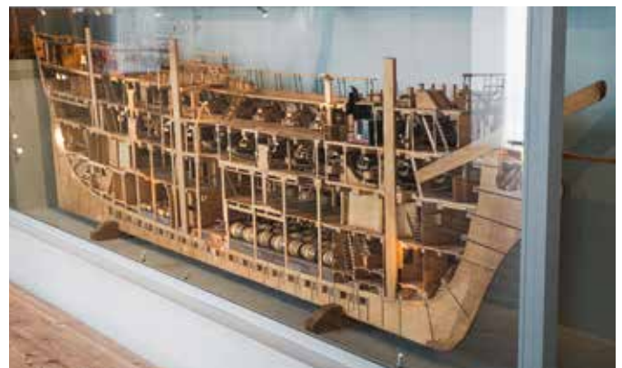
Genomskärningsmodell av Kronprins Gustav Adolf. Modellerna var dåtidens sätt att prova egenskaper och tekniska lösningar innan man började bygga i stor skala.
