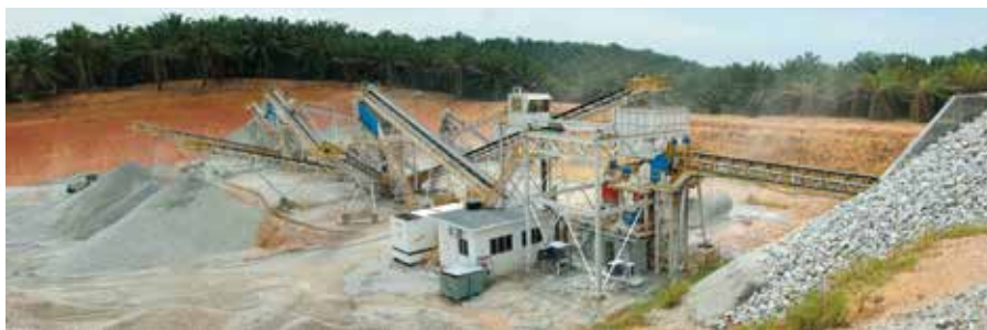
Krossanläggningen i fyra steg förser Malaysias byggindustrier med fem olika produkter.
