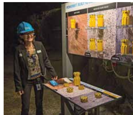
Petra Kastensson presenterar nya serien Powerbit som har plattare, trubbnosiga, stift med mer hårdmetall och större anläggningsyta.
