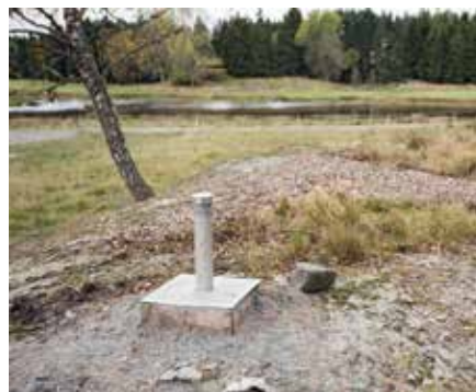
Brunn för kontroll av grundvattennivån runt täkten. Rostfri ståltopp fastgjuten i marken.
