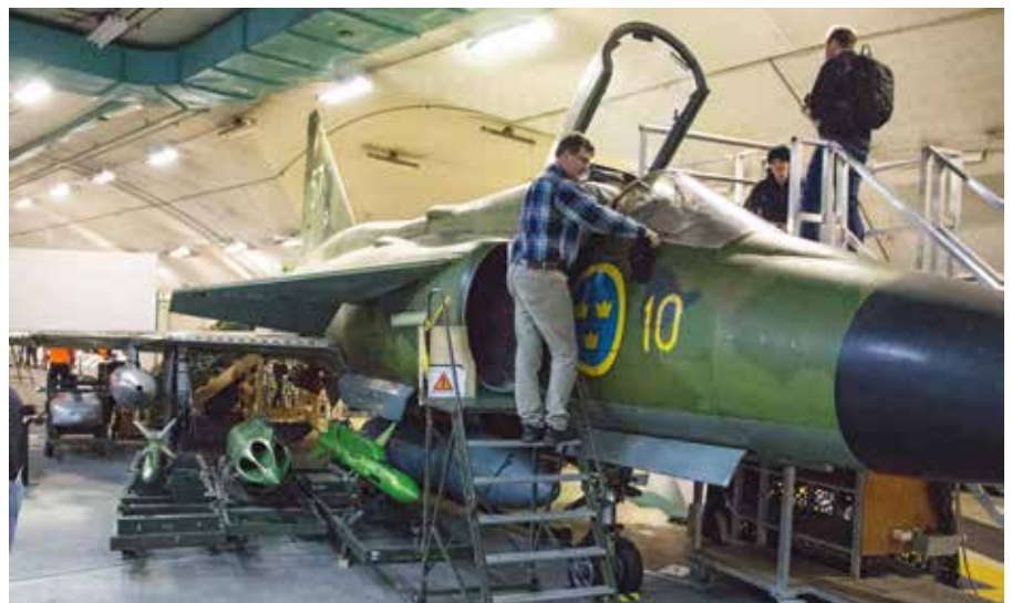
Här kan man provsitta en Saab 37 Viggen. Nosvingen framför huvudvingen tillsammans med en reverserbar motor möjliggjorde kort landningssträcka, även på halt underlag. Planet kunde alltså landa på vanliga vägar, viktigt under kalla krigets dagar. I tjänst 1971 – 2005 som attack- och skolflygplan, samt för fotospaning och havsövervakning. Viggen gjorde Mac 1 (1062 km/h) i trädtoppshöjd och Mac 2 på höjd.
