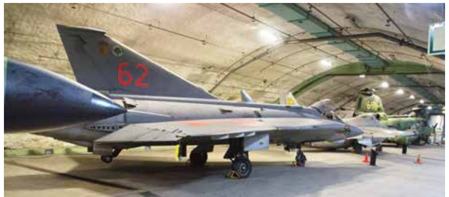
Saab J35 Draken (1955 – 1999) var världens första serietillverkade plan med dubbel deltagning, en konstruktion som togs upp av Concorde och USA:s rymdskyttel. Draken kunde stiga till 10 000 meter på 120 sek. Bränslet räckte dock endast för flygning i 30 min.
