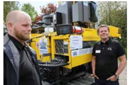
Martin och Patrik vid en Atlas T30 försedd med ett kostnadsbesparande L5 GPS höjdsystem. Man knappar in hålbotten som då hålls på centimetern oavsett hur riggen står.
