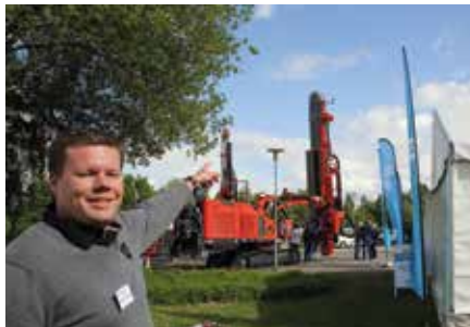
Patrik pekar på en Sandvik DX800 försedd med ett avancerat L5 GPS-system med inbyggda lutningsgivare som kan mäta från lutande stång och borra mot 3D-modeller.
