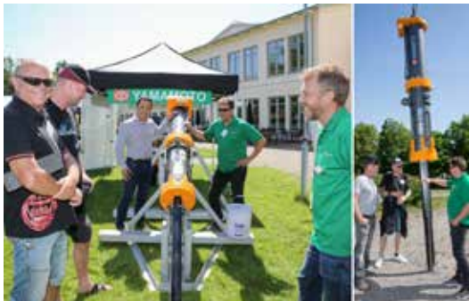
Yamamoto levererar hydrauliska bergspräckare som monteras på grävmaskin. Tre modeller: 76 mm, 102 mm och på bilden t.h. den största, 127 mm. Längst bak t.v. celebert mässbesök, Japans vd Masato Yamamoto.
