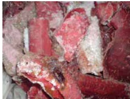
Figur 26 Exempel på miljöpåverkad dynamit av modern typ. I bilden ses en polsktillverkad dynamit av märket Minex® Eco (bilden är publicerad med tillstånd från Försvarsmakten). Foto: Anders D. Eriksson, 4:e sjöstridsflottiljen.
